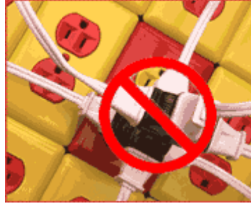
Şekil 19 Çoklu prizlere aşırı yükleme yangına neden olabilir.
